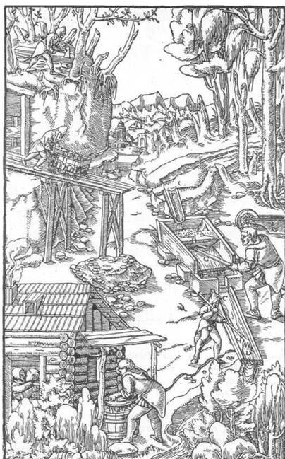
Рис. 6.2. Промывка касситеритовой руды (Г. Агрикола «12 книг о металлах»)
