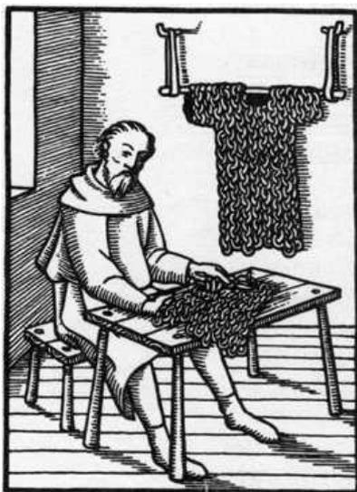
Рис. 5.6. Изготовление кольчуги
