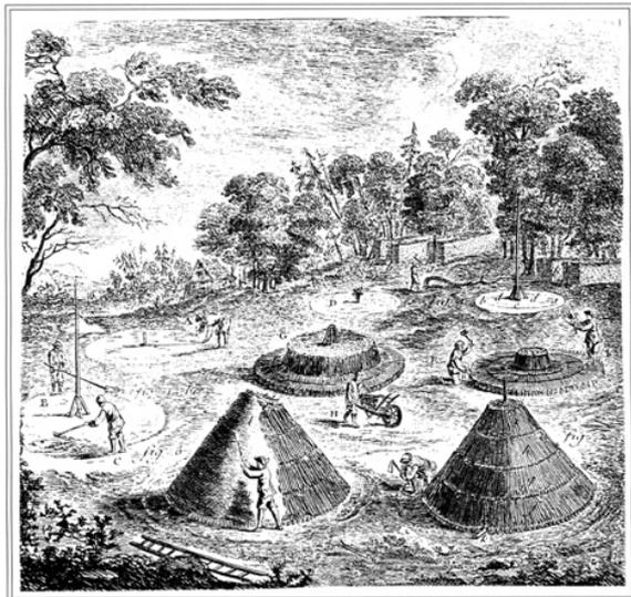
Рис. 7.27. Укладка дров для выжигания древесного угля
