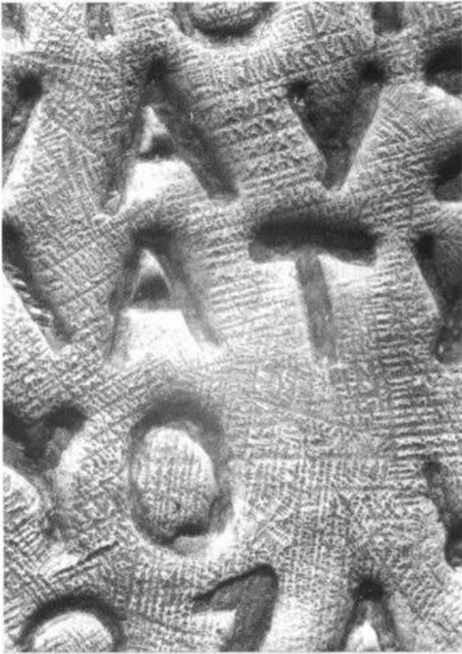
Fig. VIII. 4. Posibilă solidificare dendritică
